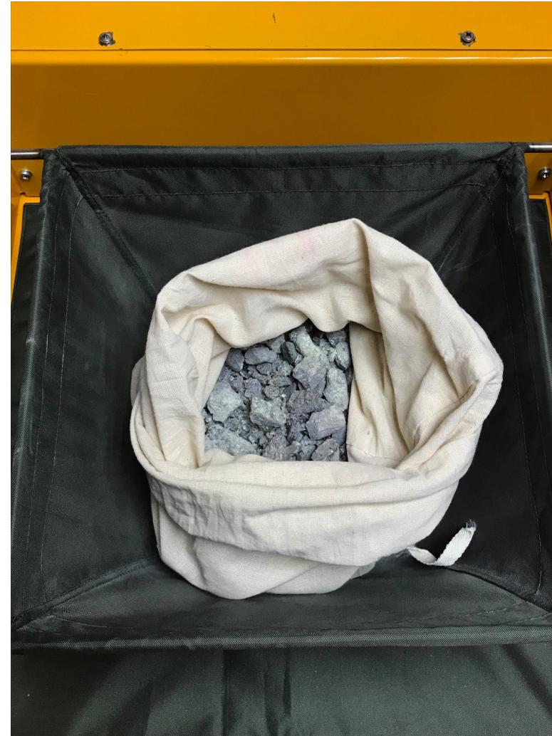
Пробы 5 кг из карьера -100 мм измерялись без какой-либо пробоподготовки. Затем дробились до -10 мм и – 3 мм.
